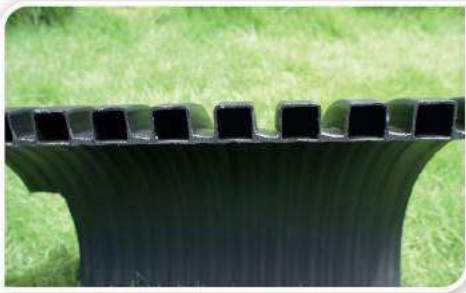
Mặt cắt ống 1 vách / Axial section of HDPE single-wall pipe
